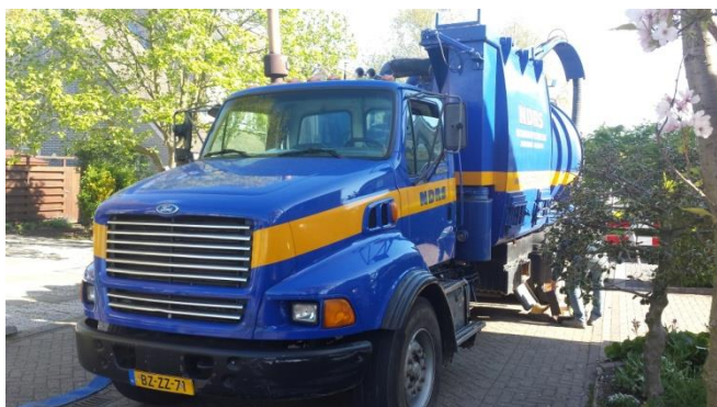
Zuigwaggen die gebruikt wordt bij het graven van de sleuven
